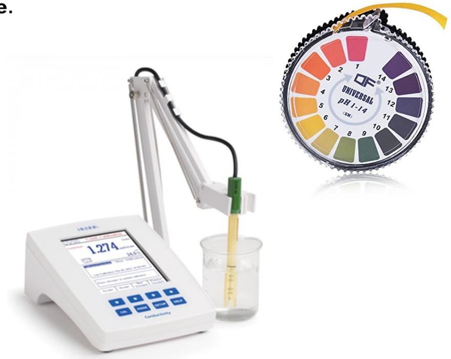
**pHmetro:** strumento semplice e di largo impiego in laboratorio che permette una misura rapida e molto accurata del pH
