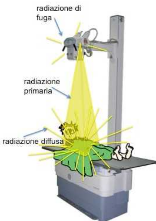
Figura 11. Schematizzazione della radiazione primaria, diffusa e di fuga generate durante il funzionamento di un tubo radiogeno
